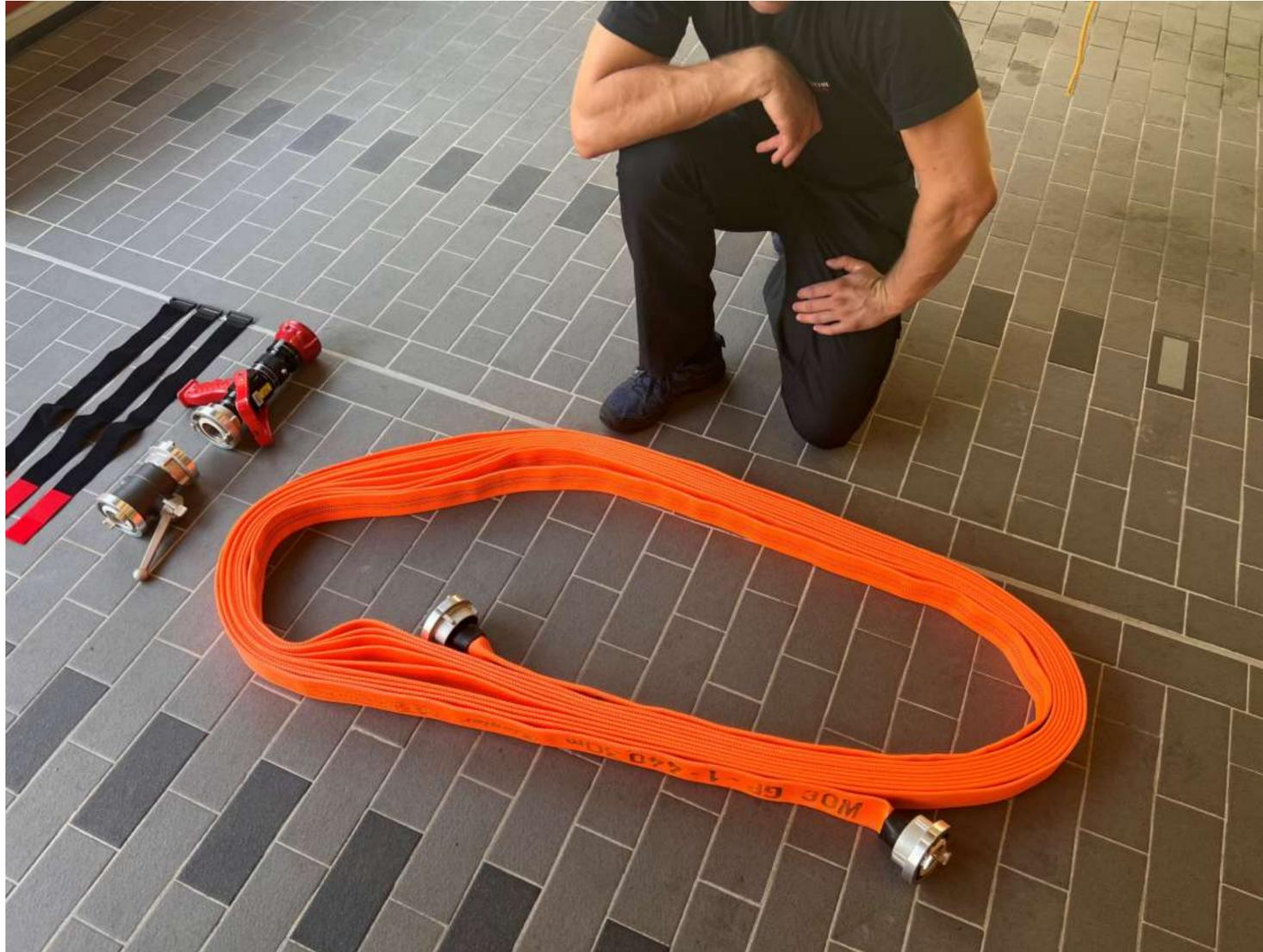
Die innere Kupplung ist so positioniert, dass das Hohlstrahlrohr hier seinen Platz findet.
