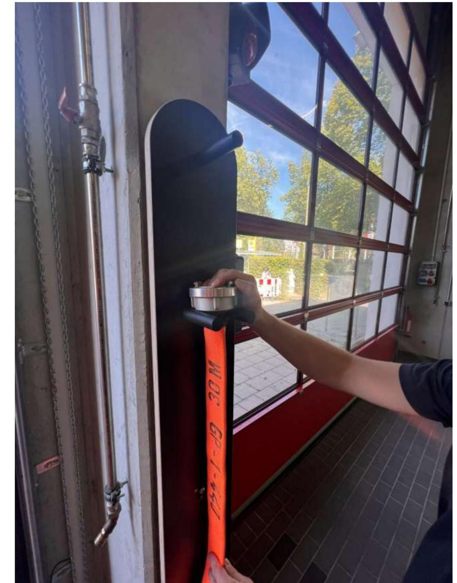
**Kupplung an den Bolzen einhängen**
