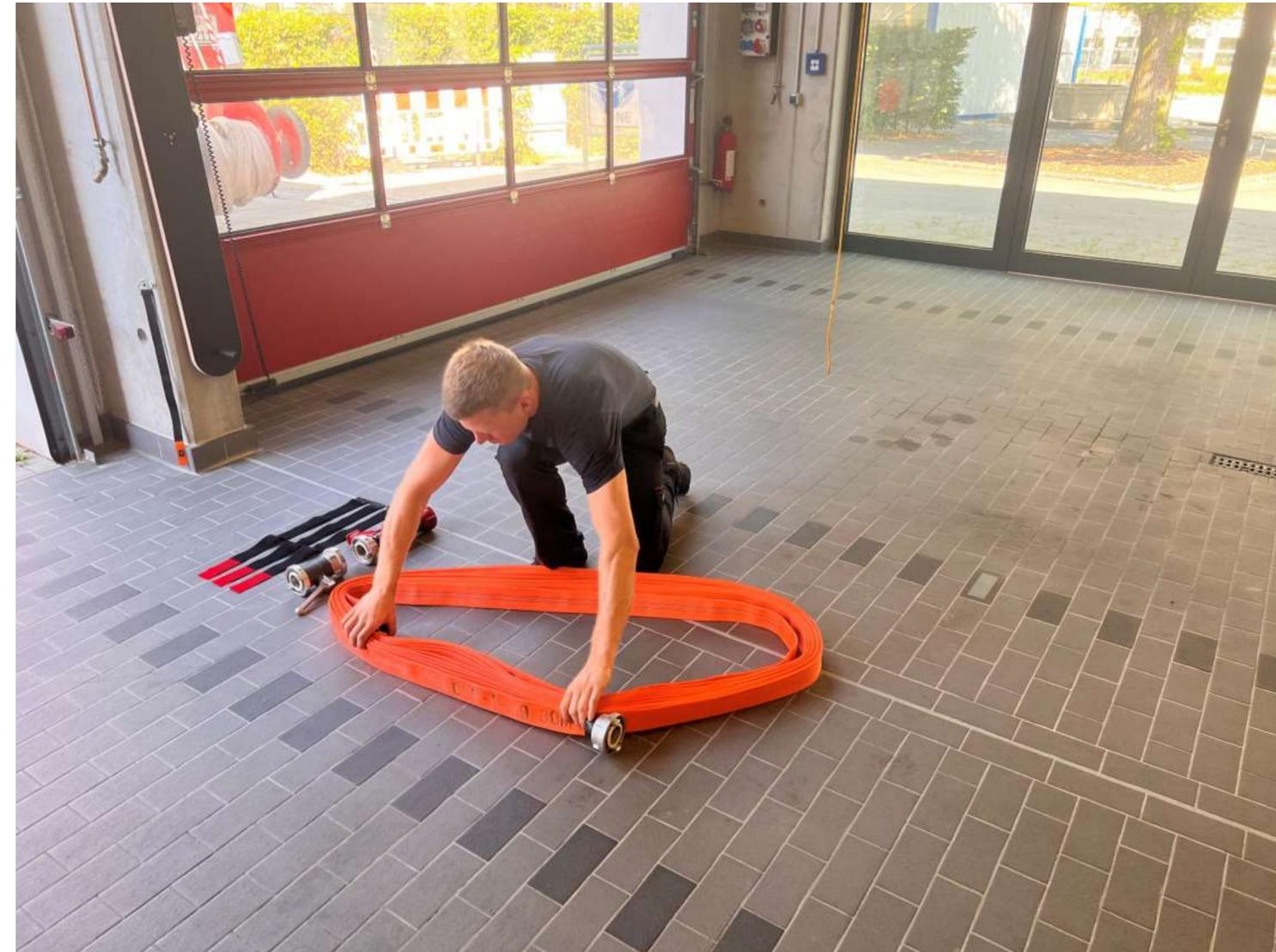
**Dann wird das gewickelte Paket auf den Boden gelegt und ausgebreitet. Anschließend wird es gegen den Uhrzeiger gedreht bis die äußere Kupplung am Ende angekommen ist, so dass noch Platz für das Absperrorgan bleibt.**
